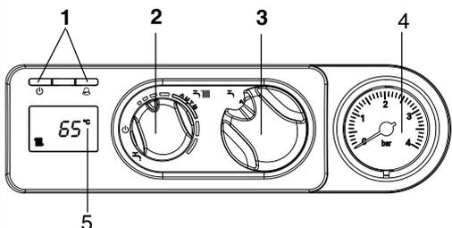
1 Led segnalazione stato caldaia
