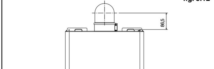
⚠ Qualora fosse necessario installare Ciao J 24 C.S.I. su impianti già esistenti (sostituzione gamme Ciao N/Mynute), è disponibile il "kit curva coassiale ribassata" che permette di posizionare la caldaia conservando lo stesso foro uscita fumi.
