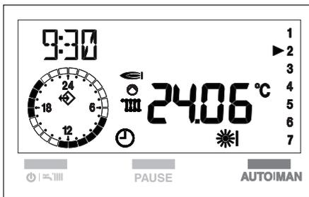
⚠ Per ritornare al funzionamento automatico, dopo un periodo funzionamento in manuale, è necessario agire sul tasto AUTO/MAN fino a visualizzare nuovamente sul display il simbolo "☀".
