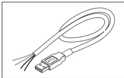
I terminali neri individuano il collegamento in ON/OFF (accesso/spento) e sono da collegare all'uscita "termostato ambiente di caldaia".
