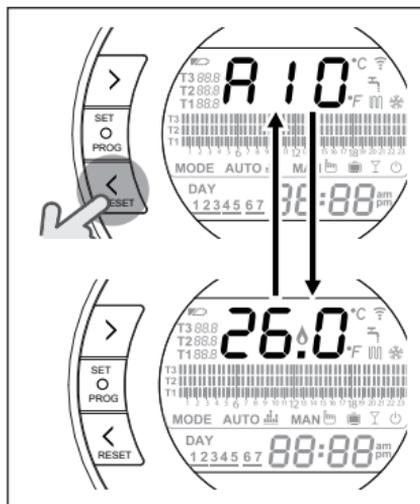
In presenza di un allarme caldaia (disponibili con collegamento OTBus tra WiFi Box e caldaia, se il protocollo OTBus lo prevede), è possibile resettare lo stesso, premendo per un secondo il tasto BACK/RESET < (se presente l'allarme A99, il reset deve essere eseguito da caldaia).
