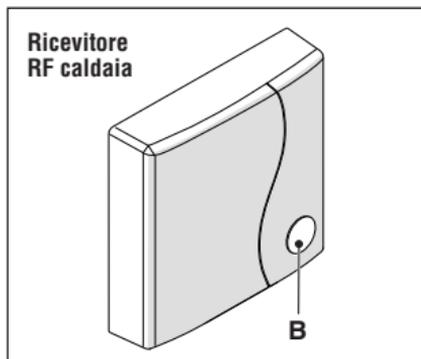
La diversa configurazione viene visualizzata con un diverso lampeggio del led verde.
