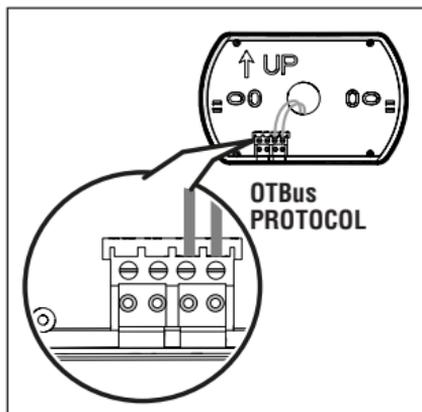
Inserire le 2 batterie di tipo AA fornite a corredo, rispettando la polarizzazione indicata.
