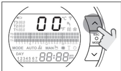
Se la password introdotta è corretta e la funzione di tasti è abilitata viene visualizzata per 5 secondi al posto della temperatura ambiente la scritta "LOC" e disabilitata la funzione di tutti i singoli tasti.
